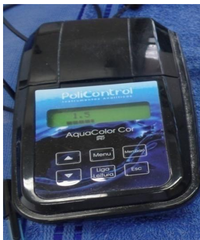
FIGURA 1: Aparelho para medir a cor da amostra de água (Colorímetro)
