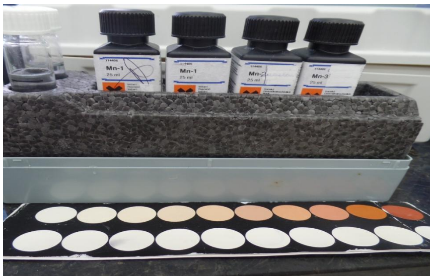
Figura 5: Reagentes para medir manganês na água
