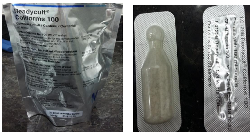
FIGURA 8: Reagente para identificação de coliforme na água
