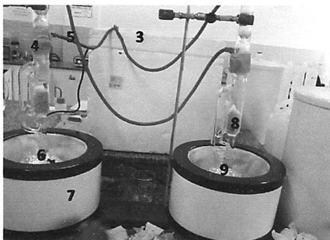
Figura 2 – Parte externa do equipamento: (3) caixa de isopor, (4) extrator Soxhlet, (5) mangueira de borracha, (6) balão de fundo redondo, (7) manta aquecedora, (8) coco catolé e (9) papel alumínio.
