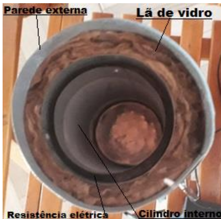
FIGURA 1: Camada de isolante térmico.
