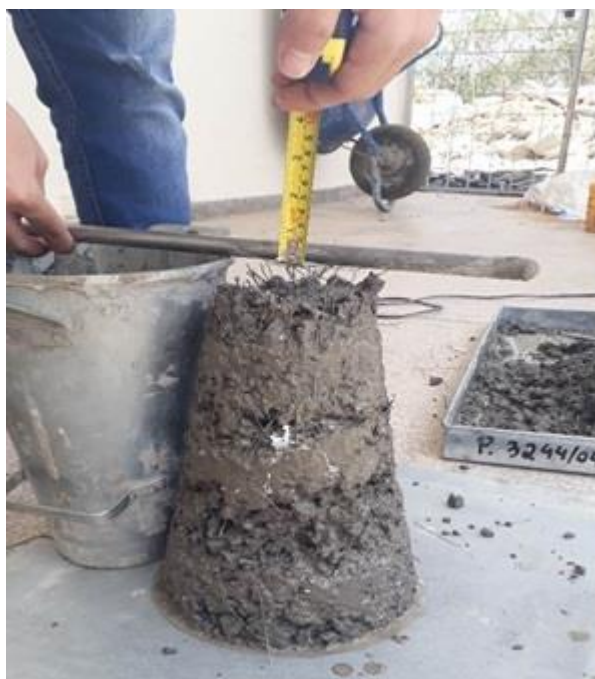
FIGURA 4: Ensaio de tronco de cone. Determinação do abatimento.
