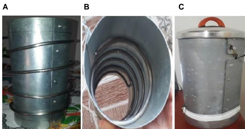
FIGURA 3: A. Cilindro interno e resistência. B. Cilindro externo a resistência. C. Cilindro externo (Cobertura) e tampas.
