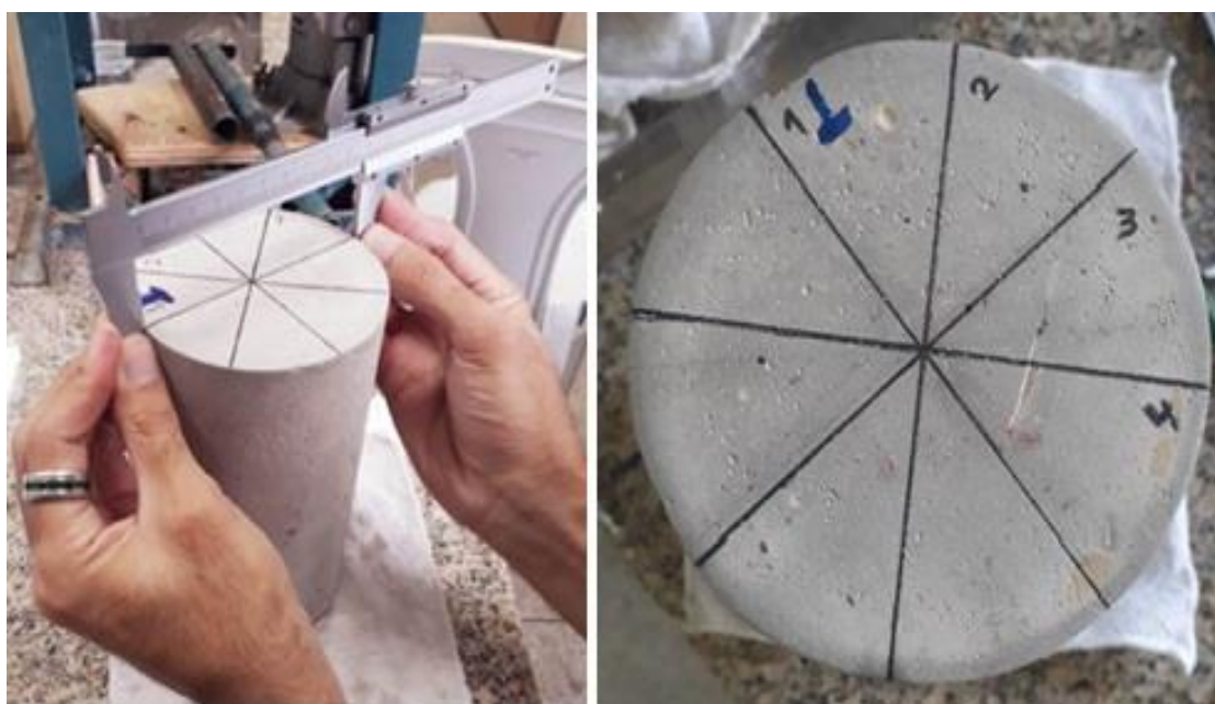
FIGURA 6: Medidas de diâmetro com paquímetro.
