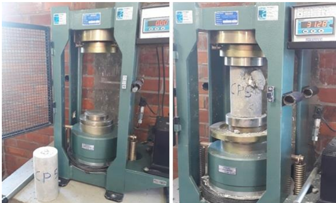
FIGURA 5: Ensaios de compressão: Lab. de Eng. Civil da FIS.
