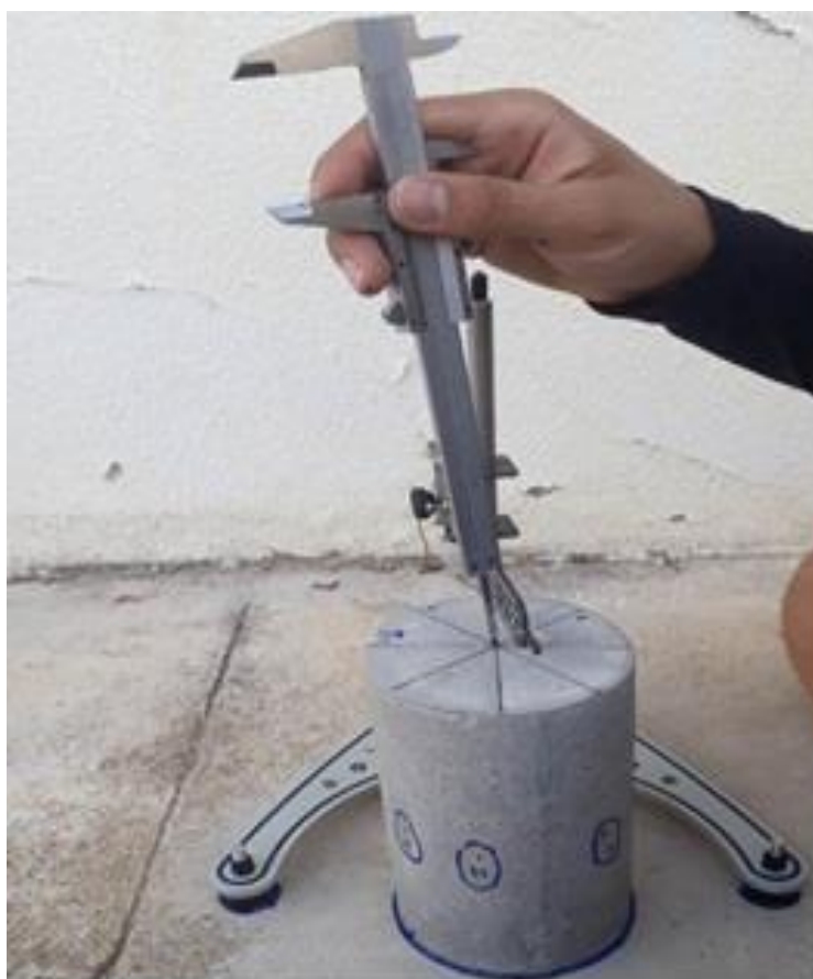
FIGURA 7: Medida de variação na altura com o paquímetro.
