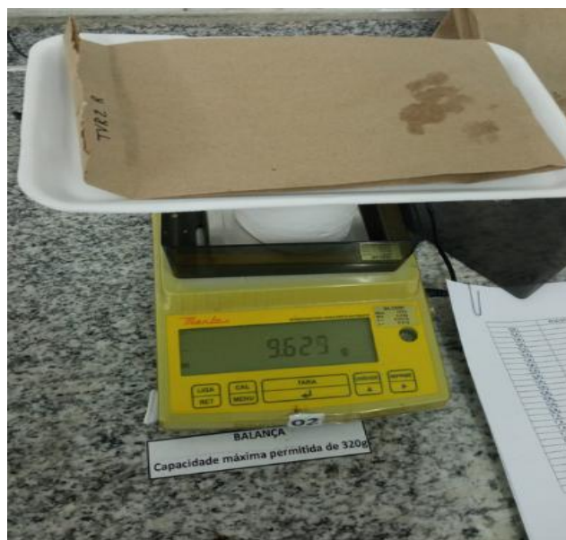
Figura 4 – Pesagem da massa fresca e seca da parte aérea e da raiz utilizando sacos de papel para armazenamento.
