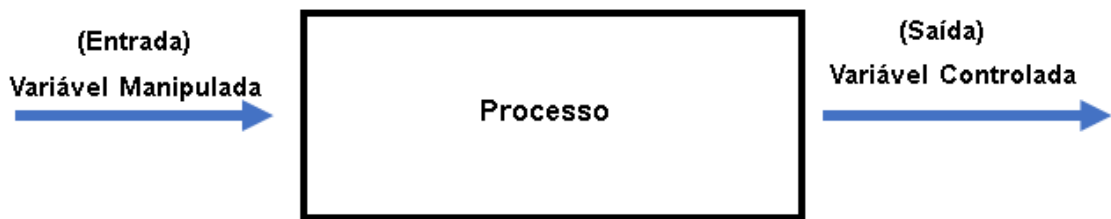
Figura 1: Principais componentes em um sistema de controle
