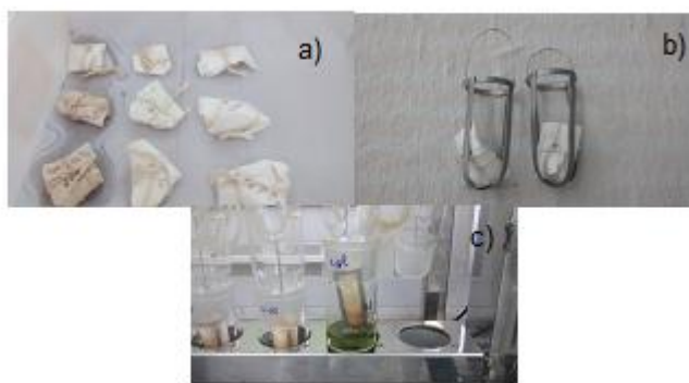
Figura 7. a) Método utilizando papel filtro embrulhado e amarrado; b) Método utilizando papel filtro embrulhado e no cesto; c) cartucho convencional
