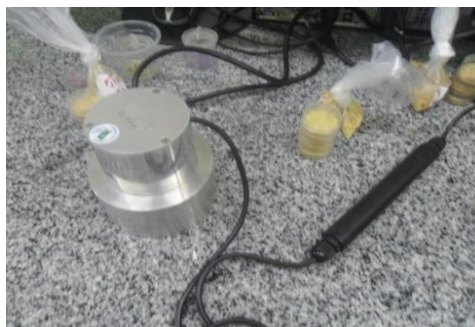
Figura 13: Aparelho portátil de atividade de água (aW)
