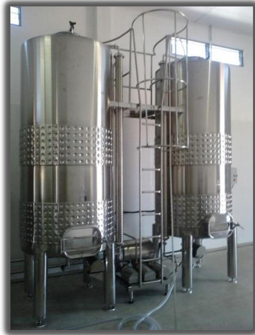
Figura 4. Tanque de maceração com controle de temperatura e sistema de remontagem constante na COANA, Petrolina-PE.
