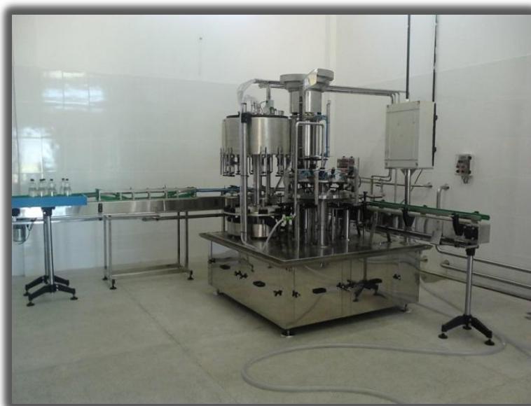
Figura 7. Envasadora gravimétrica automática com sistema de fechamento de garrafas na empresa COANA, Petrolina-PE.
