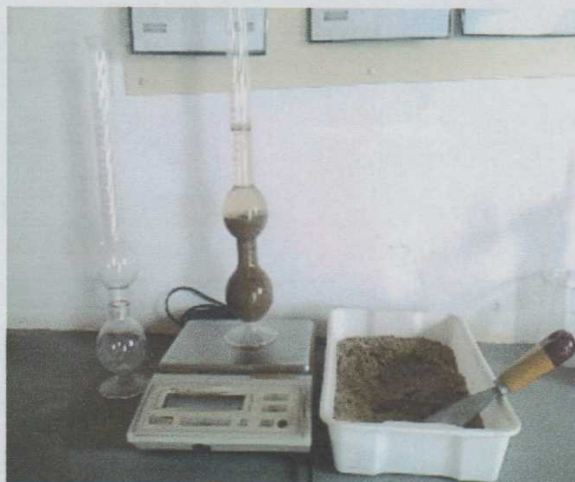
Figura 12 - Ensaio de umidade da areia Fonte: arquivo do Autor
