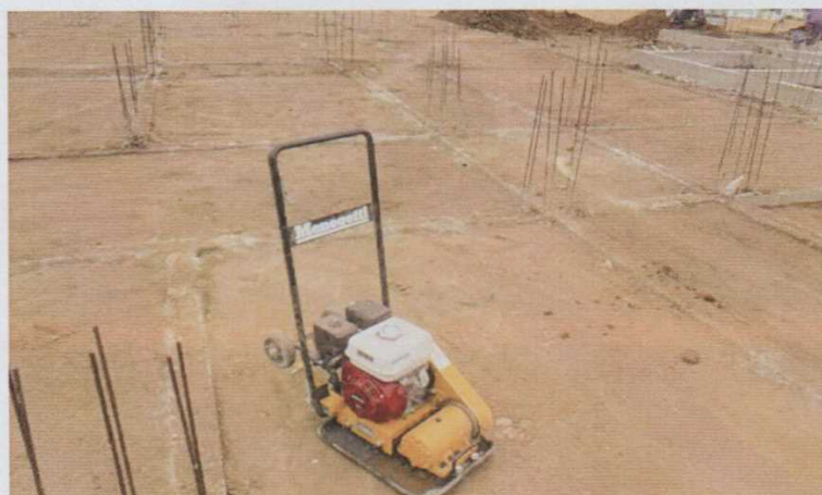
Figura 02 – Compactador a percussão unidirecional. Fonte: Vinicius Gonçalves
