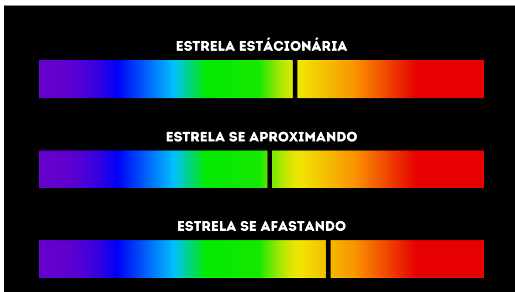
Figura 17 – Diferentes espectros de absorção formados em consequência do efeito Doppler da luz.
