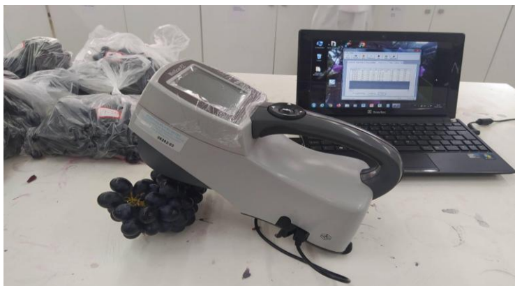
Figura 11 - Espectrofotômetro portátil (MiniScan EZ) do IFSertão Campus Petrolina.
