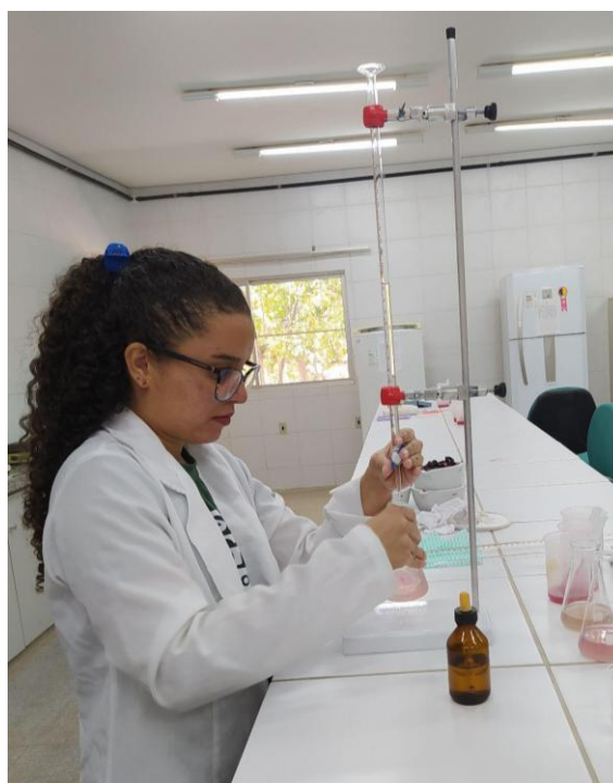
Figura 10 - Titulação utilizando NaOH para neutralização dos ácidos presentes nas amostras de suco da uva 'BRS Vitória'.
