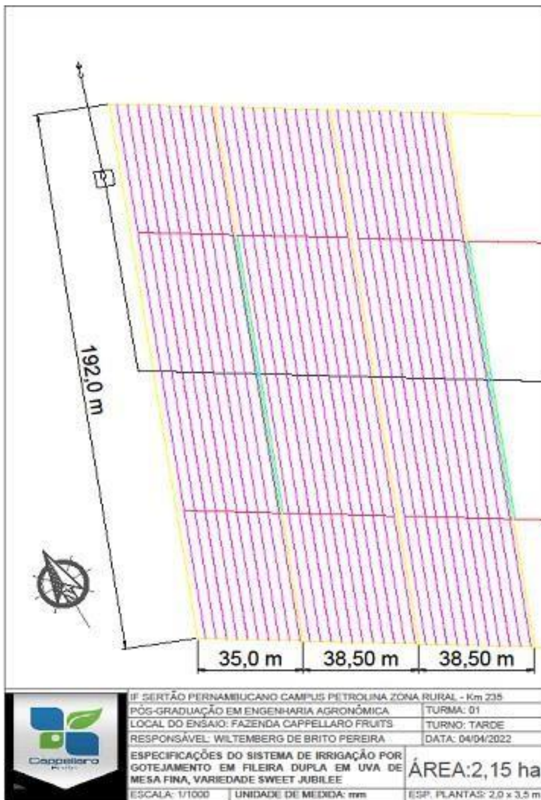
Figura 12A. Tela do software AutoCAD, saída com resultado de disposição das tubulações laterais e tamanho das subunidades avaliadas.
