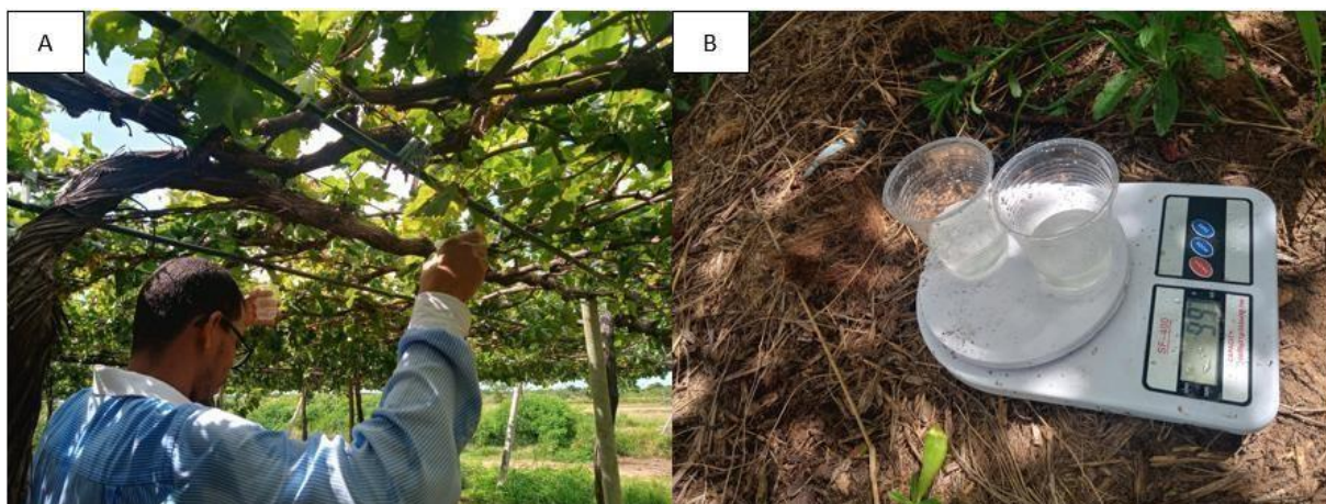
Figura 3: A) Coleta de água dos emissores simultâneos na área experimental, por subunidade. B) Pesagem do volume de água coletada.
