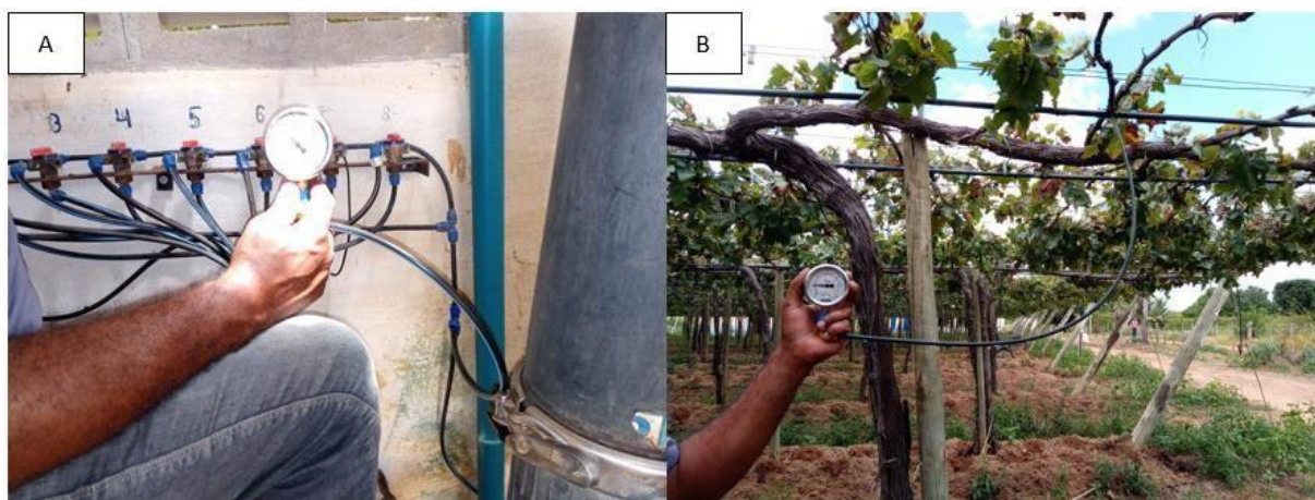
Figura 4: A) Medição de pressão na casa de filtro. B) Medição de pressão nos finais de linhas laterais.
