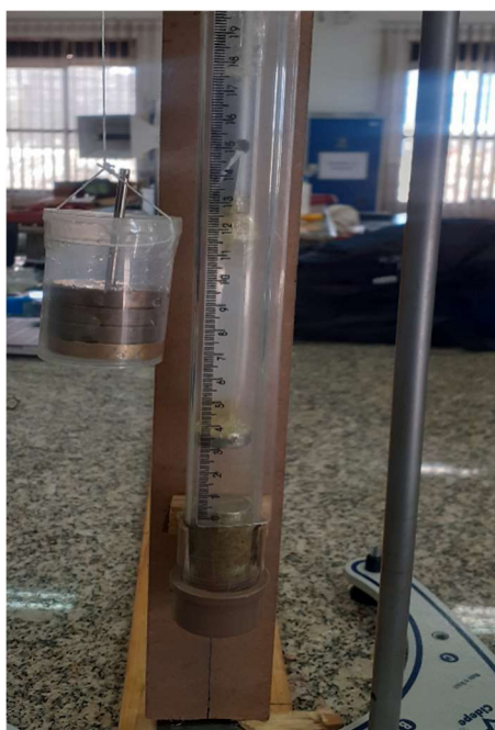
Figura 24 - Haste metálica fixa ao copo transparente.
