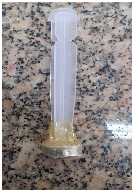
Figura 22 - Ímã de neodímio fixo ao êmbolo de uma seringa.
