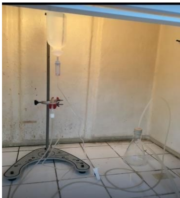
Figura 01: Sistema de Recuperação do Pesticida
