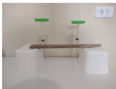
Figura 10: Experimento 4, elevador de seringas
