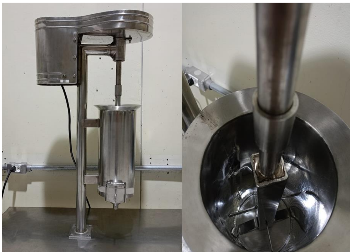
Figura 2 – Modelo de despulpadora vertical para os frutos da bacabeira.
