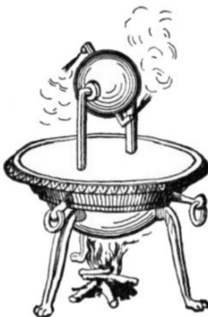
Figura 2 – Ilustração da Eolípila de Heron ou Máquina Térmica de Heron, I d.C.
