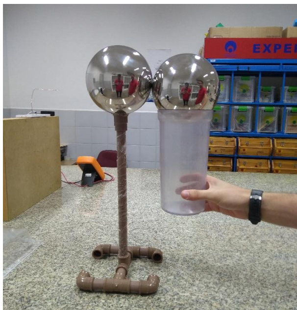
Figura 08: Divisão de carga entre esferas de aço idênticas
