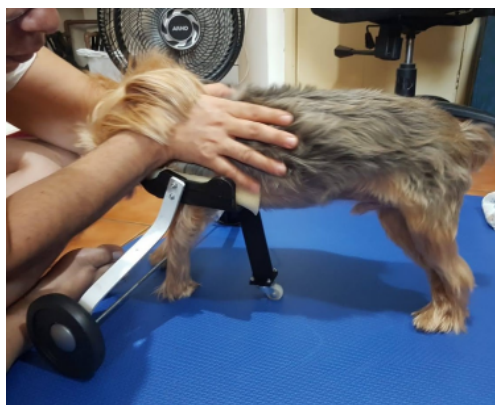
Figura 20. Cadeira de rodas sendo testada no cachorro
