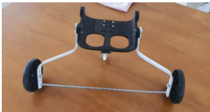
Figura 2. Cadeira de rodas impressa e montada
