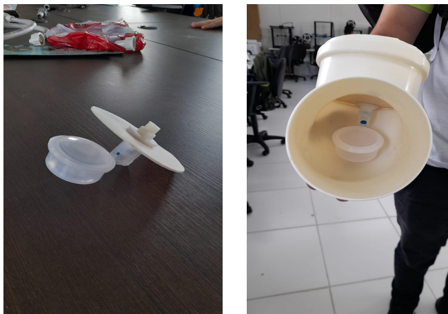
Figura 17: Montagem de chapa, boia e colagem de joelho
